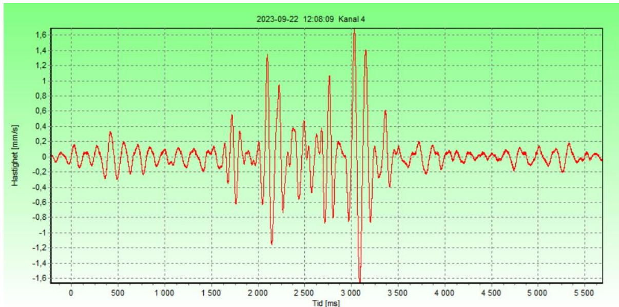
Figur 1. Kurvförlopp grundläggningsnivå vertikalt (Givare 4), 2022-09-22 12:12:08:09.
