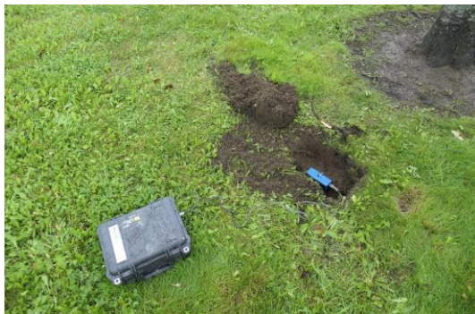
Bild 4. Givarplacering före täckning mätpunkt 1.
